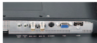
Szeroki wachlarz złącz, w tym VGA, HDMI, S-Video, wejście / wyjście BNC
