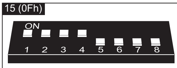
Rys. 20. Sposób ustawienia adresu w ekspanderze wyjść.
